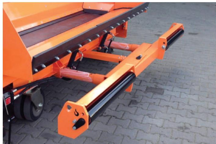
**STRASSMAYR BF 290** машината е опремена со водено ладен KUBOTA дизел мотор и има моќен хидрауличен систем што ја управува транспортната трака за материјал. Капацитетот на поставување хидраулички се прилагодува, како и аголот на инклинација, дебелината на слојот, прилагодување со камионот што доставува материјал, и др.
