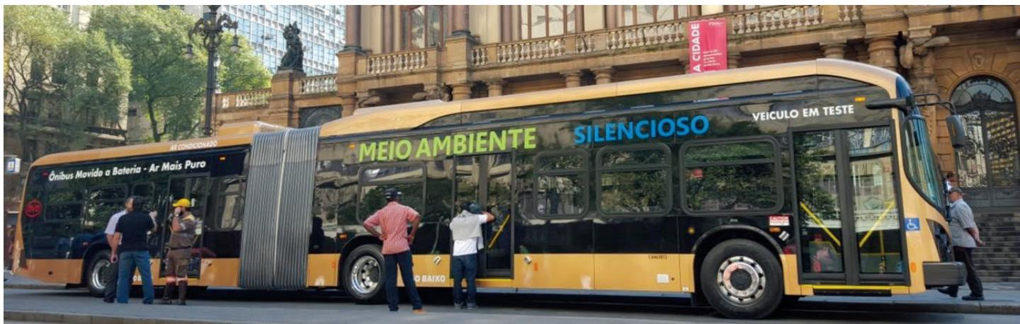
максимален вртежен момент секој му обезбеђуваат максимална брзина од скоро 100 километри на час. И покрај се, тежината на празното возило е задржана на 21,5 тона, а може да искачува нагорници до 21%.
