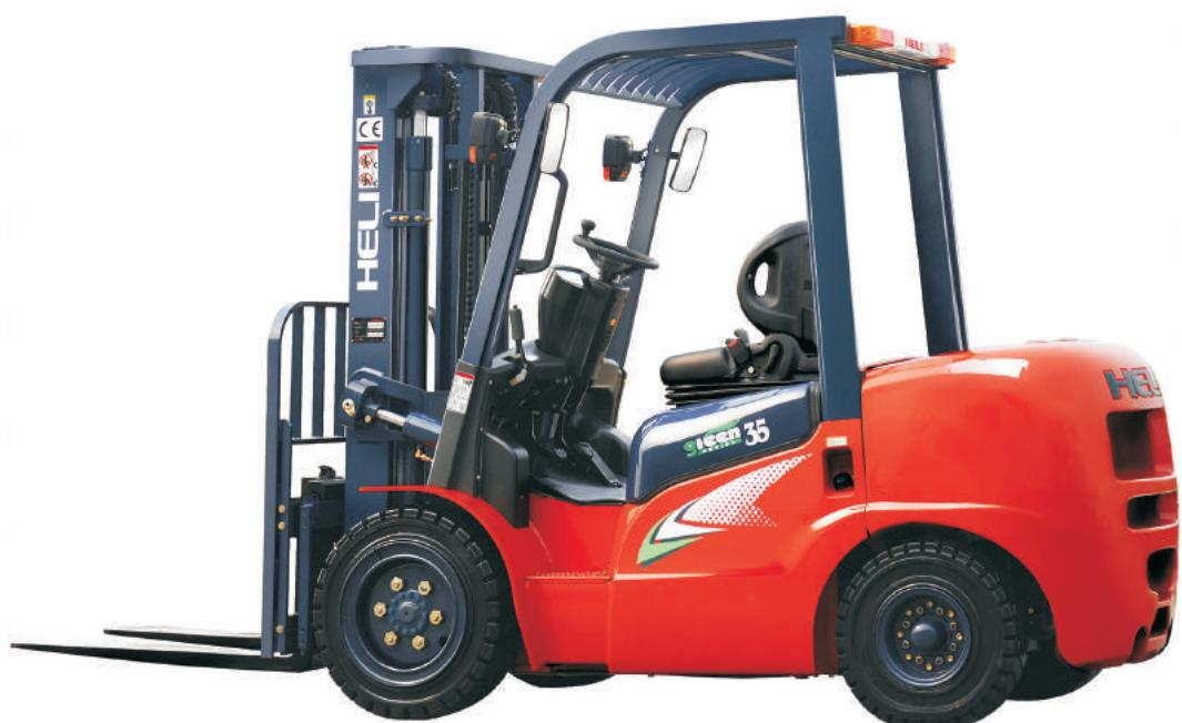
Еколошки прифатливите Isuzu или Kubota дизел мотори им обезбедуваат максимална брзина од 19 km/h, а трансмисијата е хидраулична со автоматски пренос со по еден степен за возење напред и назад. Стандардно доаѓаат со дуплекс јарбол со висина на подигнување од 3.000 mm, а можат да биде опремени и со дуплекс или триплекс јарбол со висина на подигнување до 6.000 mm. Должината на вилушките кои имаат 3 хидраулични команди изнесува 1.220 mm, класата за нивно закачување е 3A, а гумите се пневматски.
