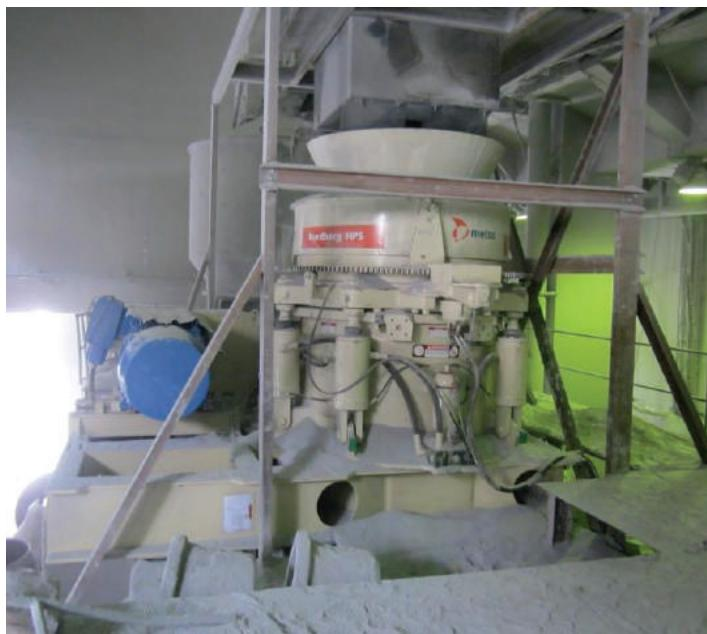
е ремонтирана примарната конусна дробилка Allis Chalmers со димензии 48x74 инчи. Во втората и третата фаза е извршена анализа на постоечките постројки задробување и просејување. Притоа поради укажаната потреба за постигнување на поголем капацитет, посiten производ како и стабилно производство, инсталирани се три Nordberg HP6 дробилки, се со цел понатамошна оптимизација на капацитетот на секцијата задробување.
